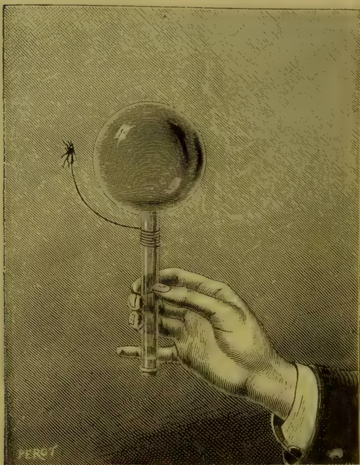
Fig. 123. Microscopio semplice formato da una sfera di vetro piena d'acqua.
